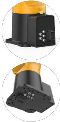
两种出线方式 Two connection outlets
